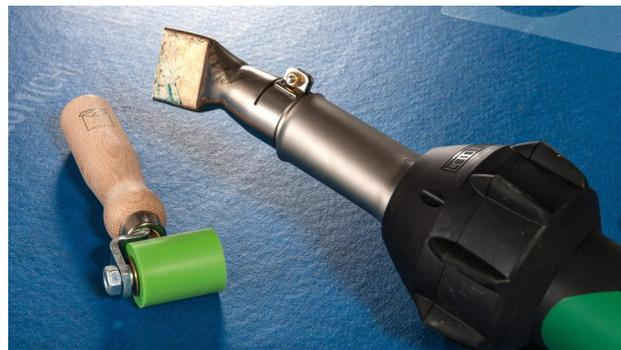
**5a. Alternativ: Überlappung verschweissen mit Heissluftgerät**
