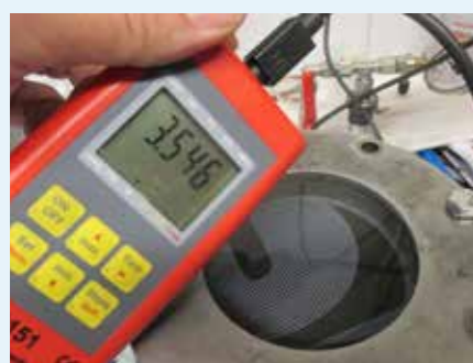
Abb. 24 a/b: Hydrostatischer Druckversuch im Labor – mittel Überdruck durch Pressluft wird eine künstliche Wassersäule simuliert. Gute Unterdeckbahnen erreichen Werte von über 2.500 mm.
