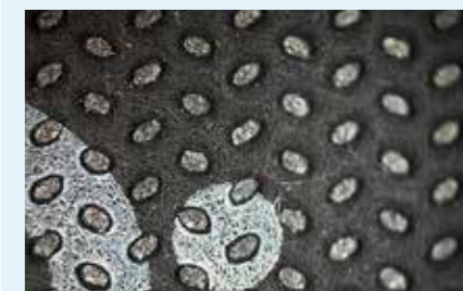
Abb. 37: Mikroskop-Aufnahmen einer SOLITEX MENTO 3000 Unterdeckbahn nach 24 Wochen Freibewitterung – keine Schäden erkennbar
