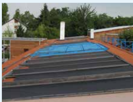
Abb. 35: Freibewitterungsstand zur Untersuchung der Alterungsbeständigkeit bei direkter Bewitterung
