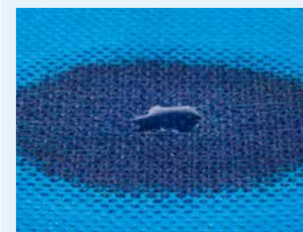
Abb. 26 b: Oberflächenspannung von Wasser herabgesetzt durch chemische Substanz, keine ausgeprägte Tropfenbildung, geringer Zusammenhalt des Wassers, Wasser kann eher durch Poren hindurchdringen.
