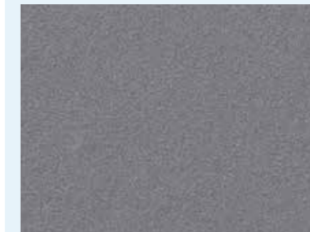
Abb. 16: Monolithische Membran – Mikroskopaufnahme mit 1000-facher Vergrößerung, geschlossene/porenlose Funktionsschicht
