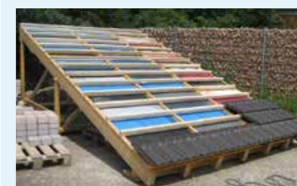
Abb. 38 a/b: Testdach zur Untersuchung der Alterungsbeständigkeit von Unterdeckbahnen im eingedeckten Nutzungszustand
