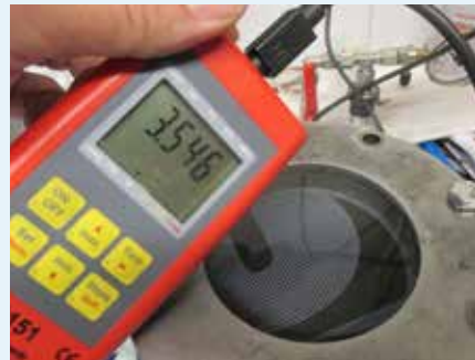
Abb. 24 a/b: Hydrostatischer Druckversuch im Labor – mittels Überdruck durch Pressluft wird eine künstliche Wassersäule simuliert. Gute Unterdeckbahnen erreichen Werte von über 2.500 mm.
