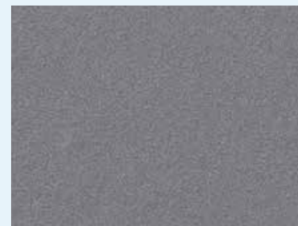
Abb. 16: Monolithische Membran – Mikroskopaufnahme mit 1000-facher Vergrößerung, geschlossene/porenlose Funktionsschicht
