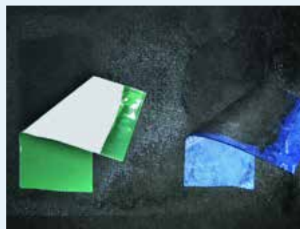
Abb. 41: Wasserfestigkeit von Klebebandern. Links: Klebeband mit wasserlöslicher Acrylat-Emulsion »verseift« und verflüssigt unter Wassereinfluss. Rechts: Klebeband mit wasserfestem SOLID-Kleber, Trennung der Verklebung nur zerstörerisch möglich
