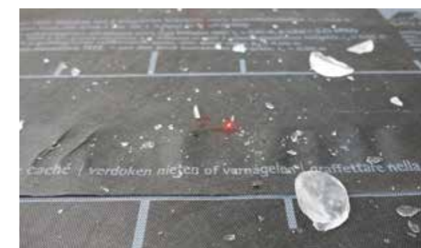
pro clima Unterdeckbahnen weisen auch nach mehrfachem Beschuss mit den größtmöglichen Hagelkörnern keine Beschädigungen auf und sind nach wie vor wasserdicht.
