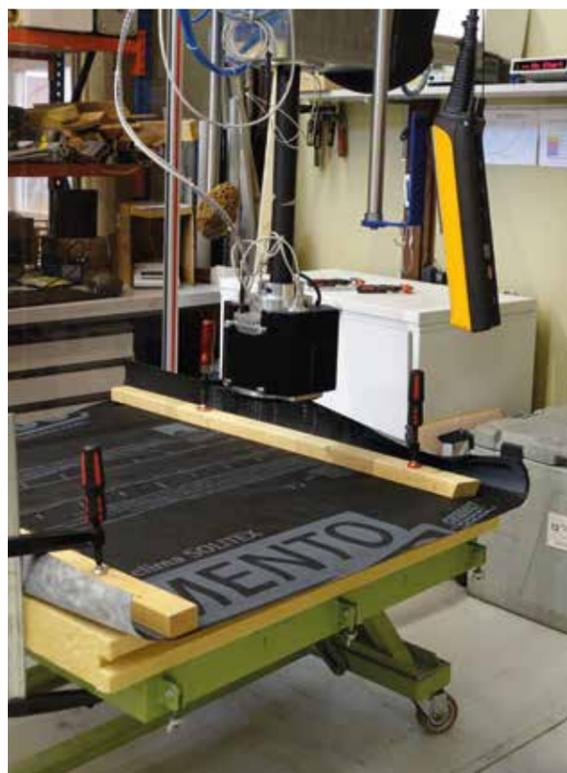
Avec un canon à grêle, les grêlons peuvent être tirés jusqu'à 110 km/h
