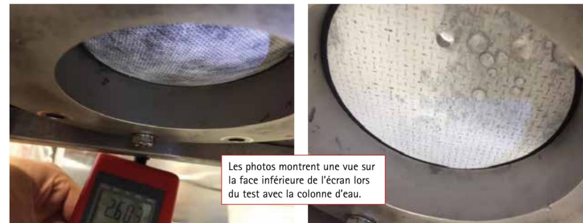
Les photos montrent une vue sur la face inférieure de l'écran lors du test avec la colonne d'eau.
