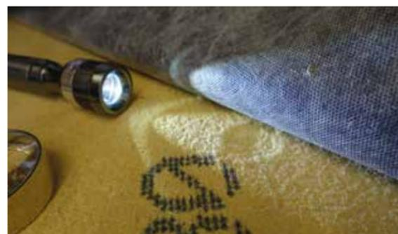
Après avoir subi la projection de grêlons de 50 mm de diamètre, le panneau en fibres de bois sous-jacent présente une déformation d'environ 4 mm.
