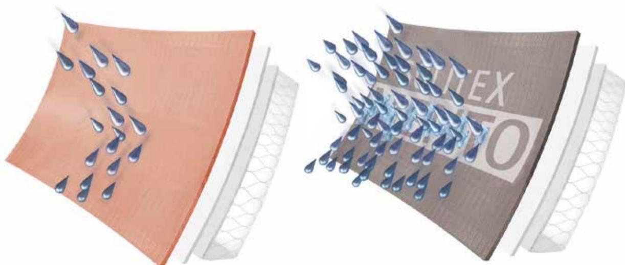
Dans ce cas, l'utilisation d'un film TEEE monolithique assure l'étanchéité à l'eau particulièrement élevée. Ce film allie une étanchéité à l'eau élevée avec des propriétés de diffusion optimales et une résistance au vieillissement éminemment forte.
