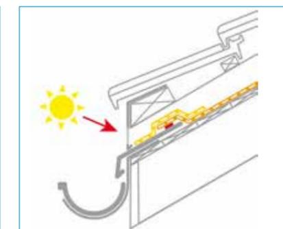
La sous-toiture est amenée directement dans la gouttière. Veiller à protéger l'écran des UV au niveau du pied de versant.
