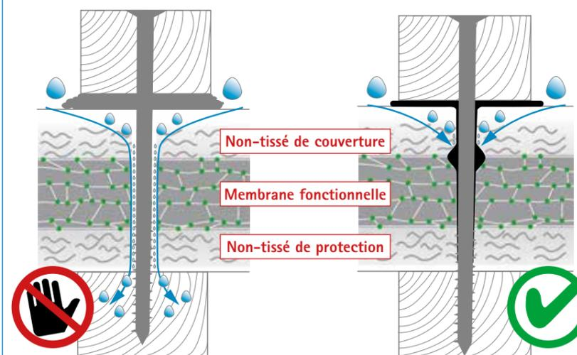
Les taquets d'étanchéité à base de mousse rendent seulement étanche le non-tissé ; de l'eau présente dans le non-tissé drainant supérieur peut pénétrer à travers le percement de la membrane.
