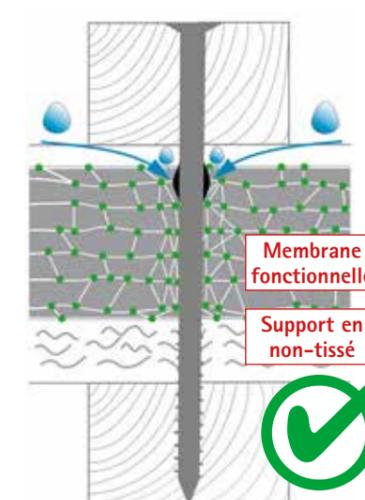
En cas de support résistant à la pression ( $\geq 100$  kPa : panneaux en fibres de bois / panneaux dérivés du bois), la haute étanchéité et l'élasticité de la membrane fonctionnelle reste durablement étanche à l'eau contre les moyens de fixation.
