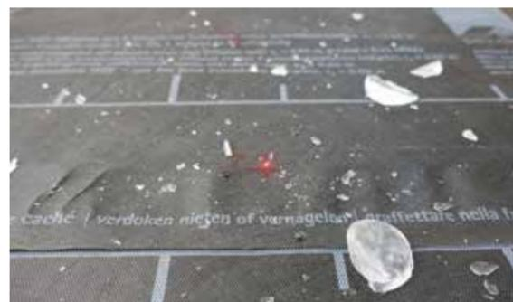
Les écrans de sous-toiture pro clima restent intacts, même après avoir subi la projection de grêlons au diamètre maximal.
