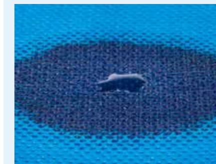
Abb. 26 b: Oberflächenspannung von Wasser herabgesetzt durch chemische Substanz, keine ausgeprägte Tropfenbildung, geringer Zusammenhalt des Wassers, Wasser kann eher durch Poren hindurchdringen.
