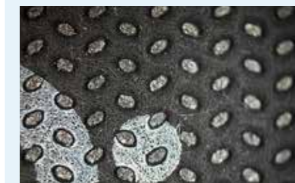
Abb. 37: Mikroskop-Aufnahmen einer SOLITEX MENTO 3000 Unterdeckbahn nach 24 Wochen Freibewitterung – keine Schäden erkennbar
