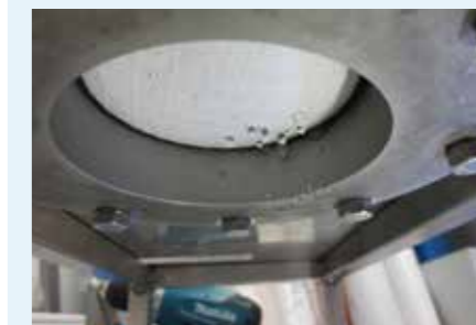
Abb. 38 a/b: Testdach zur Untersuchung der Alterungsbeständigkeit von Unterdeckbahnen im eingedeckten Nutzungszustand
