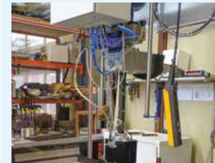
Abb. 33: Prüfung der Hagelsicherheit. Mit einer Hagelkanone können Hagelkörner auf Bahnen mit Geschwindigkeiten von bis zu 110 km/h geschossen werden.
