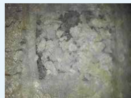
Abb. 36 a/b: Mikroskop-Aufnahmen von Unterdeckbahnen nach 13 Wochen Freibewitterung zeigen Rissbildung und massive Auflösungserscheinungen
