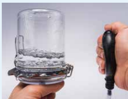
Abb. 18: Testbottle als einfache Möglichkeit zur Feststellung von Mikroporen – mittels Handpumpe wird Druck unter der Bahn der Bahn aufgebaut; bei Mikroporen dringt Luft hindurch und steigt blasenförmig im Wasser auf
