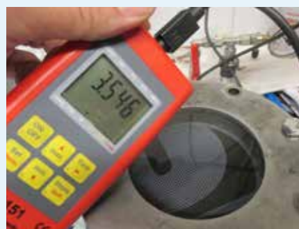
Abb. 24 a/b: Hydrostatischer Druckversuch im Labor – mittels Überdruck durch Pressluft wird eine künstliche Wassersäule simuliert. Gute Unterdeckbahnen erreichen Werte von über 2.500 mm.
