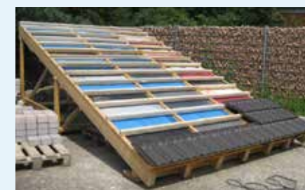
Afb. 37 a/b: Beprouvingsdak voor het testen van de verouderingsbestendigheid van dakfolies in gedekte toestand.
