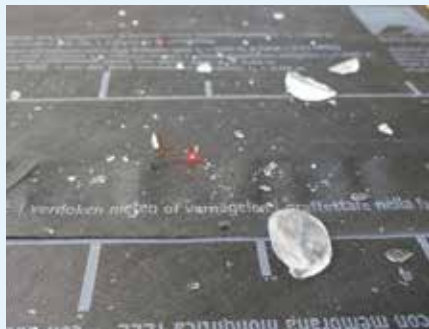
Afb. 33: SOLITEX-dakfolies op zachtboard blijven ook bij meerdere beschietingen met hagelstenen met een diameter van 50 mm onbeschadigd.
