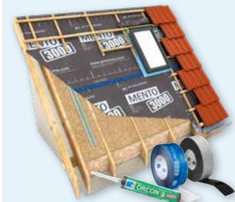
Afb. 45: Dakfolie en toebehoren – voor het realiseren van aansluitingen, het verlijmen van overlappingsen en het afdichten van nagelperforaties zijn deels toebehoren nodig. Hiervoor kunnen het best systeemcomponenten van de foliefabrikant worden gebruikt.
