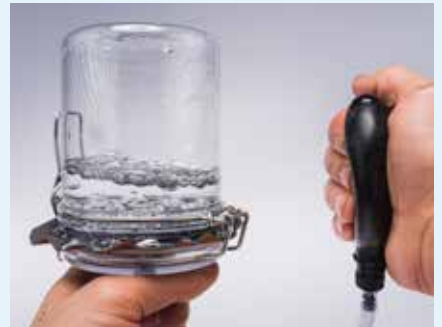
Afb. 17: Testfles om snel microporiën te identificeren – met een luchtpompje wordt druk onder de folie opgebouwd. Bij microporiën dringt lucht door de folie en stijgen er luchtbelletjes op in het water.
