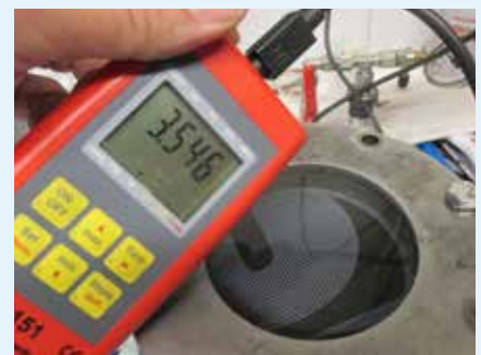
Afb. 23 a/b: Hydrostatische drukproef in het laboratorium – middels overdruk door perslucht wordt een kunstmatige waterkolom gesimuleerd. Goede dakfolies bereiken waarden van meer dan 2500 mm.
