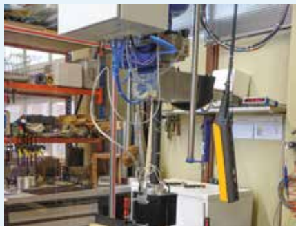
Afb. 32: Beproeving van de hagelweerstand. Met een hagelkanon kunnen hagelstenen met snelheden van max. 110 km/h op folies worden geschoten.
