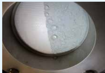
Afb. 25 b: Oppervlaktespanning van water gereduceerd door chemische stof: geen duidelijke druppelvorming, geringe samenhang van het water, water kan eerder door poriën dringen.
