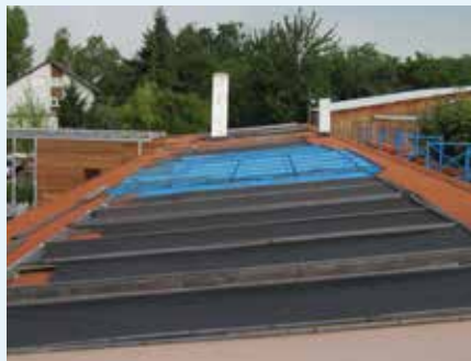
Afb. 34: Buitenopstelling voor het onderzoeken van de verouderingsbestendigheid bij rechtstreekse blootstelling aan weersinvloeden.
