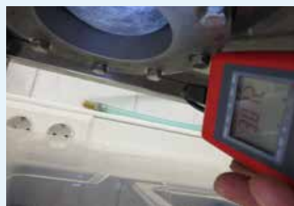
Afb. 38 a/b: Hydrostatische drukproef na 2 jaar natuurlijke veroudering onder dakbedekking; boven: microporeuze folie ondicht bij waterkolom <0,6cm; onder: SOLITEX MENTO 3000 bereikt waarden >3 m.
