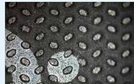
Afb. 36: Microscopie-opname van een SOLITEX MENTO 3000-dakfolie na 24 weken blootstelling – geen schade herkenbaar.
