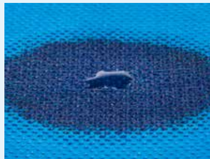
Afb. 25 b: Oppervlaktespanning van water gereduceerd door chemische stof: geen duidelijke druppelvorming, geringe samenhang van het water, water kan eerder door poriën dringen.
