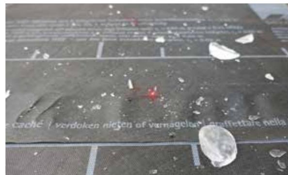
Les écrans de sous-toiture pro clima restent intacts, même après avoir subi la projection de grêlons au diamètre maximal.
