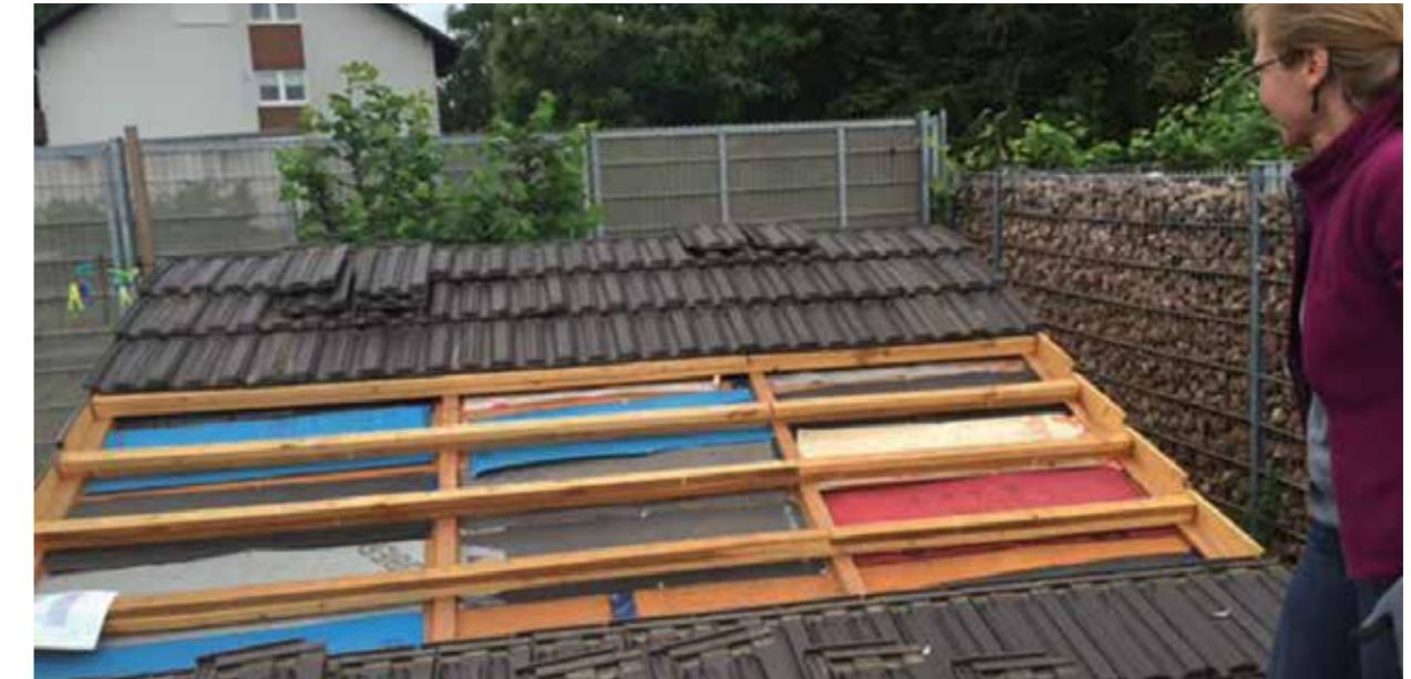
Analyse d'écrans de sous-toiture (pose libre tendue) de différents fabricants 5 ans après la mise en oeuvre
