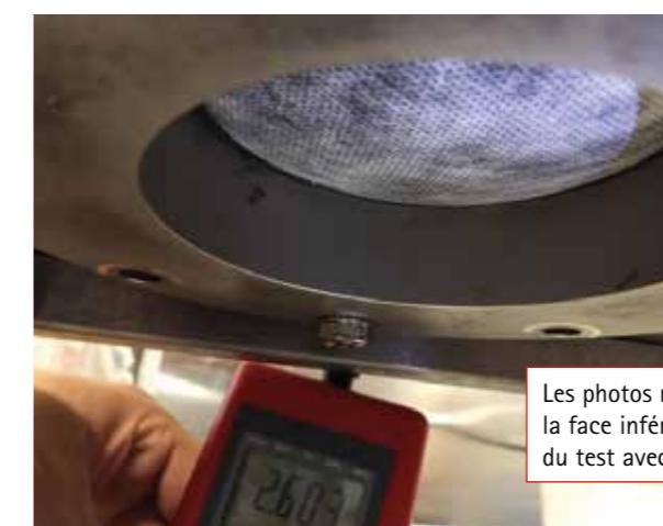
Test avec colonne d'eau d'un écran SOLITEX MENTO 3000 après cinq ans de vieillissement naturel sous la couverture du toit ; sec à 2600 mm.
