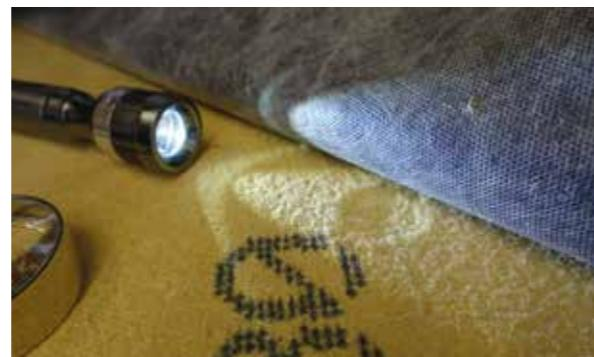
Après avoir subi la projection de grêlons de 50 mm de diamètre, le panneau en fibres de bois sous-jacent présente une déformation d'environ 4 mm.
