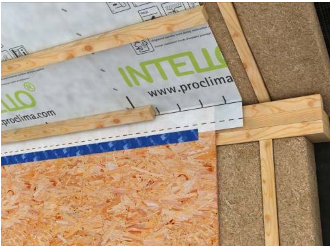
Figure 25 : Raccord en pied de versant au mur à ossature en bois (avec panneau bois comme barrière à la diffusion de vapeur d'eau) à l'aide d'un ruban adhésif PRO CLIMA
