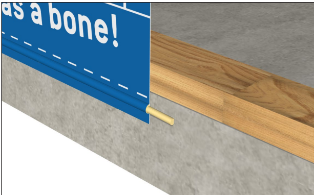
14. 形成弹性密封 切勿将胶条完全压扁，以保持持久弹性密封。
