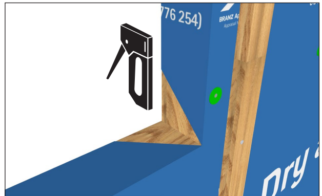
17. 固定翼片 沿窗洞侧壁后缘用订钉固定翼片，钉距150毫米均匀分布。 注意：这是唯一允许使用订钉的部位。
