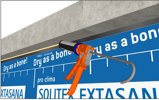
12. 用ORCON® CLASSIC密封中间楼板 SOLITEX EXTASANA®的30毫米搭接区应使用ORCON® CLASSIC胶条粘贴于中间楼板。
