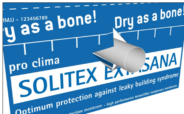
24. 将管道穿出 推动管道使翼片张开。按需修剪翼片，以便安装ROFLEX和TESCON EXTORA®
