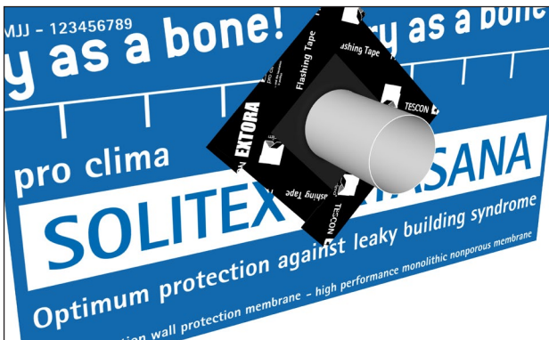
27. 贴覆TESCON EXTORA® 沿整个密封套逆时针缠绕TESCON EXTORA®,确保上层压下层。
