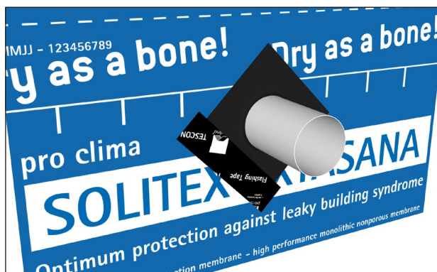
26. 贴覆TESCON EXTORA® 在底边贴60毫米宽的TESCON EXTORA®,并用PRESSFIX工具加压。
